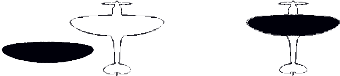
Figure 3 : L'aile elliptique se superpose à la silhouette du Spitfire.
